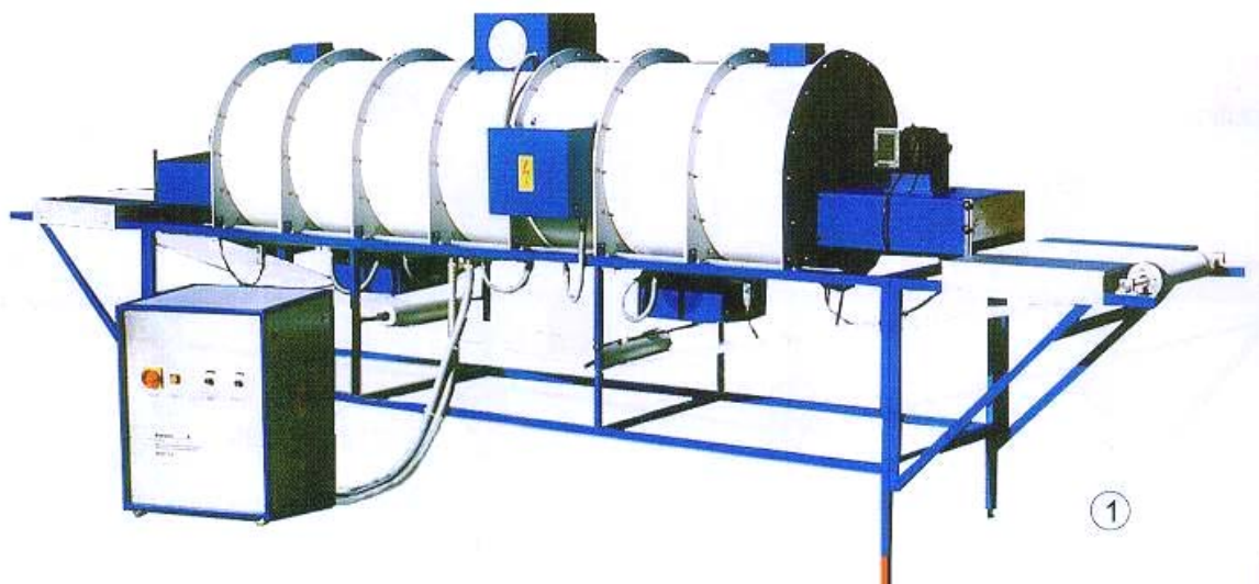
รูปที่ 1.5: แสดงตัวอย่างเตาให้ความร้อนด้วยคลื่นไมโครเวฟ
