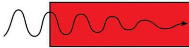
Absorbierend, teilweise Durchdringung Absorbing, partial penetration
