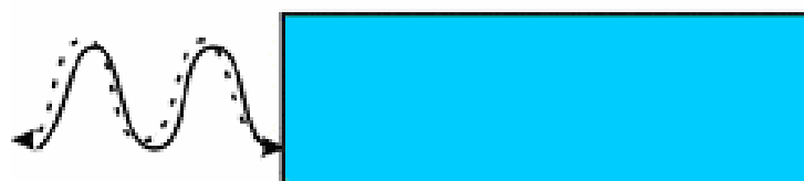
Reflektierend, keine Durchdringung Reflecting, no penetration
