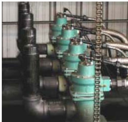
รูปที่ 4.1: แสดงการติดตั้งหัวเผาแบบเชลล์-รีคัพเปอร์เรทีฟกับเตาเผา (3)
