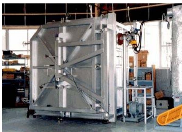
รูปที่ 4.1: แสดงการติดตั้งหัวเผาเรเจนเนอเรทีฟกับเตาเผา (4)
