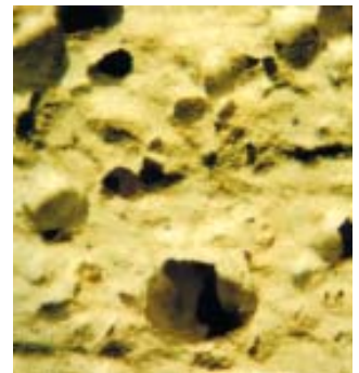
รูปที่ 2 ลักษณะโพรงอากาศของคอนกรีตมวลเบาประเภท AAC
