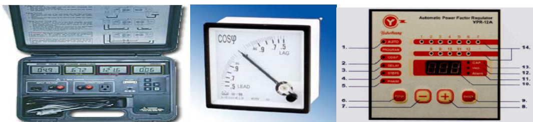
รูปที่ 2.7 เครื่องวัดตัวประกอบกำลังไฟฟ้า (Power Factor Meter)
