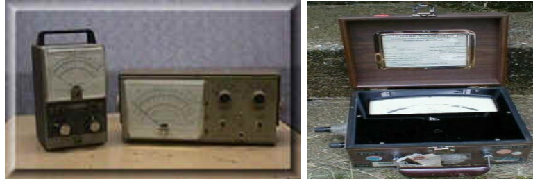
รูปที่ 2.5 เครื่องวัดแรงดันไฟฟ้า (Voltmeter)
