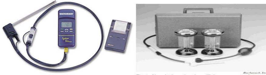
รูปที่ 2.8 เครื่องมือทดสอบการเผาไหม้ (Combustion Tester)
