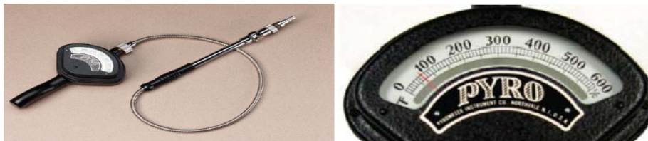
รูปที่ 2.2 เครื่องวัดอุณหภูมิผิว (Surface Pyrometer) และหัววัดประเภทต่าง ๆ กัน
